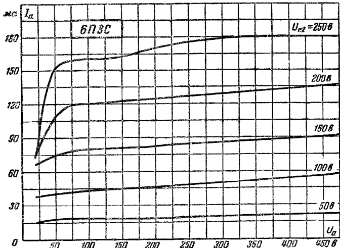
Рис. 19. Анодные характеристики лампы 6П3С при U_{c1} = 0 в.
