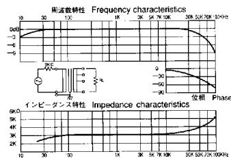
新素材アモルファス（非晶質合金）を使用した真空管用出力トランス、5極管、3極管、その他多種類の真空管と組んで多種多様な回路でお使いになれます。奥行きと広がりをもった新しい音の世界が想像されます。
